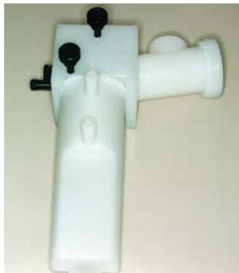
**Figura 11.** Conjunto completo de nebulizador/cámara de nebulización
