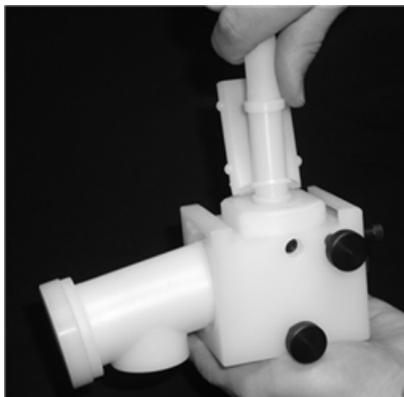
**Figura 12.** Enrosque el tubo de drenaje de plástico en el bloque del nebulizador
