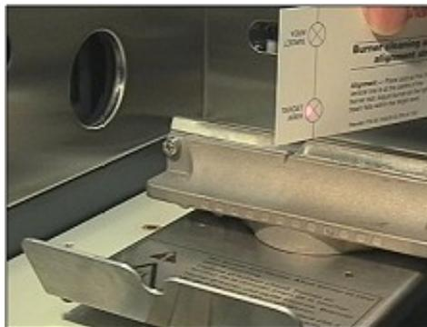
**Figura 22.** Alineación del quemador
