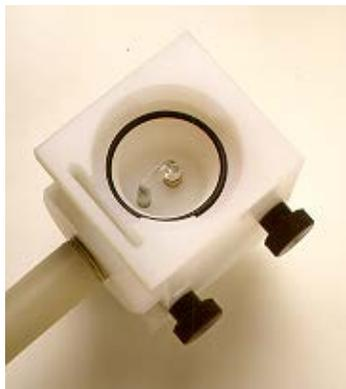
**Figura 9.** Junta tórica colocada en el bloque del nebulizador.
