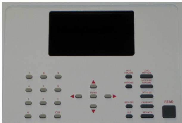
**Figura 15.** Área de teclado y visualización del sistema de AA Agilent 55B
