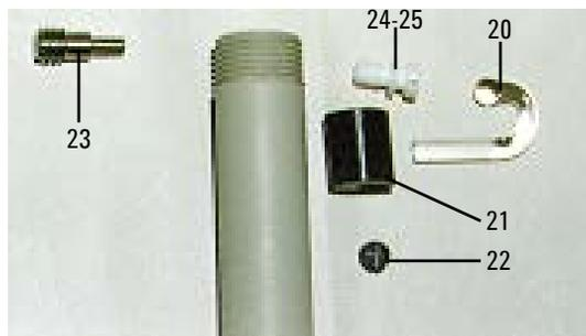
**Figura 32.** Diversos componentes del bloque del nebulizador
